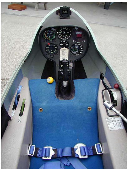
L'abitacolo dell'aliante monoposto Grob Astir. Si notano il pomello giallo dello sgancio e ben tre variometri installati nel cruscotto
